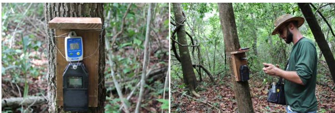
Figura 2. Método de monitoramento acústico passivo (MAP).
